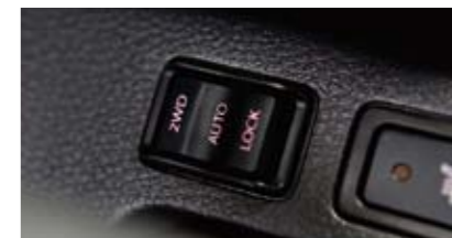
▲ Jednotlivé režimy pohonu se ovládají zde. Vůz může mít i jen přední pohon.
