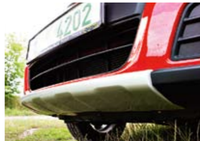
▲ Vypadá to jako chránič spodku, ale ve skutečnosti jde pouze o efektní plast.
